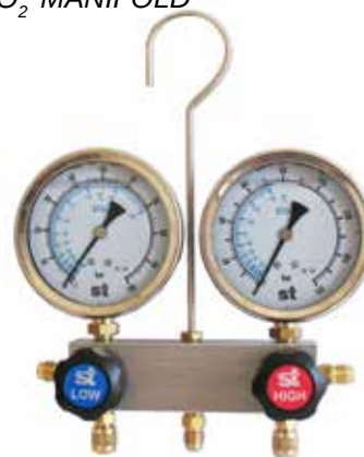
ANALIZADOR CO 2 CO 2 MANIFOLD
