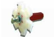
Seis enderezadores de aletas, en uno sólo, permiten limpiar y enderezar las aletas de condensadores y evaporadores a distancias de 8, 9, 10, 12, 14 y 15 aletas por pulgada.
