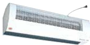
Las cortina ADA impide las fugas de frío de las cámaras frigoríficas. Gracias a su compacto diseño y a la entrada de aire situada en la parte frontal, la cortina necesita muy poco espacio libre entre el techo y la parte superior de la puerta. Equipada con un sencillo sistema de interconexión que permite cubrir huecos más anchos instalando varias unidades seguidas
